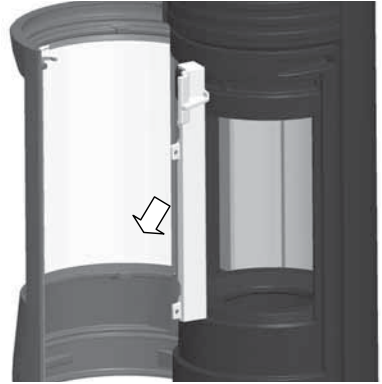
Abb. 5.4 Nur einen seitlichen Luftkanal demontieren
