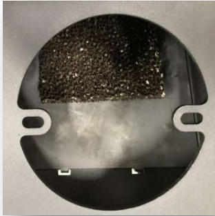
Katalysator im Kaminofen von oben betrachtet
