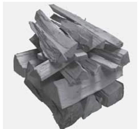
Abb. 4.10 gesamte Holzaufgabe beim Anheizen
