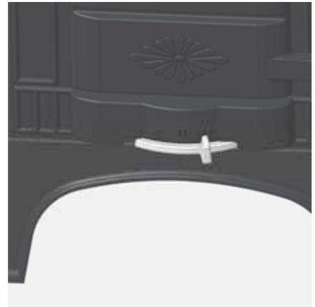
Abb. 4.6 Verbrennungsluftschieber ganz rechts, Markierung „III“, Verbrennungsluft komplett geöffnet, Anheizen
