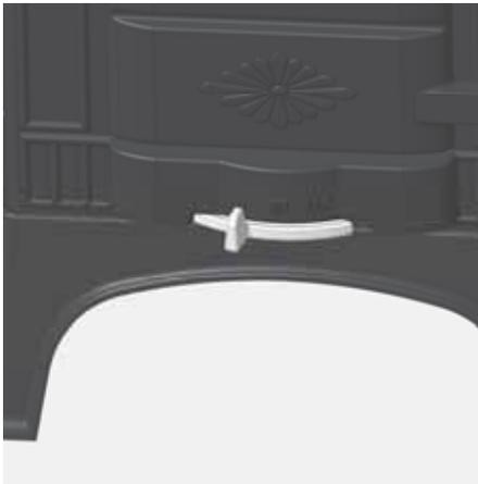
Abb. 4.4 Verbrennungsluftschieber ganz links, Markierung „I“, Verbrennungsluft geschlossen
