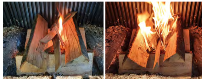
Perfekter Anzündvorgang in Feuerraummulde mit Anzündler und Anzündhölzern zwischen der oberen Holzlage.
