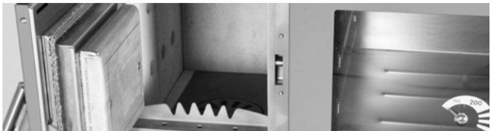
Vor der Inbetriebnahme den Drehrost, durch betätigen des Ziehhebels im Aschekasten, öffnen. So reinigen Sie auch vor jedem Betrieb den Drehrost von anfallender Asche. Lassen Sie den Drehrost zum Anheizen für einige Minuten geöffnet, um den Abbrand zu beschleunigen.
