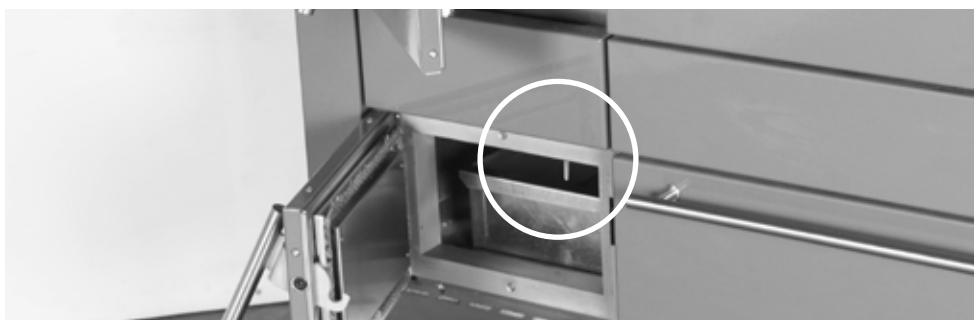
Ziehen Sie zum Anzünden die Anheizklappe, damit der Rauch nicht durch den Herd geleitet wird, sondern das Ofenrohr zügig erhitzt, so dass der Schornstein den notwendigen Zug entwickelt. Dies dauert ca. 15-20 Minuten.
