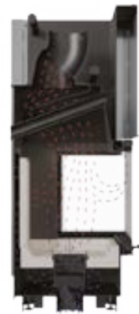
Die Übersicht über die Luftzirkulation im Inneren der Einsätze aus der FRAM 3-Serie
