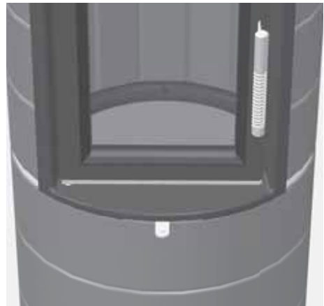
Abb. 4.8 Verbrennungsluft-Schieber, in der Mitte, Betrieb bei Nennwärmeleistung
