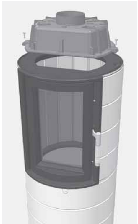
Abb. 3.31 Montieren der Gusskuppel (Wärmetauscher)
