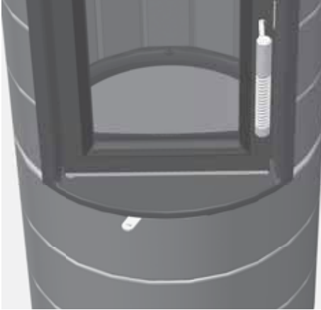
Abb. 4.3 Verbrennungsluft-Schieber, links, ganz geschlossen
