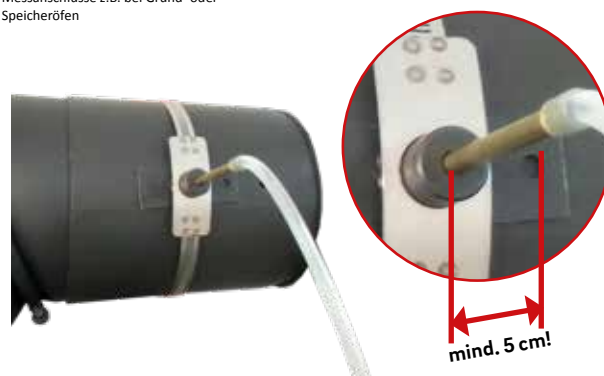
Abb. 4: Das Druckmessrohr \varnothing 6 mm am Druckmessadapter montieren.
