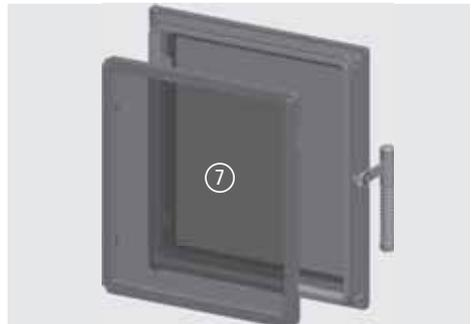
Abb. 3.14 Einbau des Dichtrahmens
