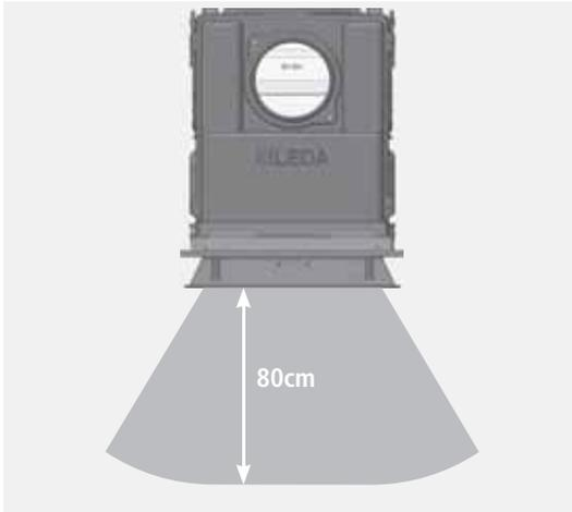
Abb. 1.2 Strahlungsbereich der Sichtscheibe - schematische Darstellung
