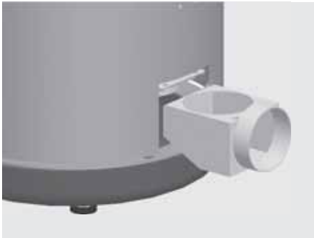
Abb. 3.7 NOVIA C: Anschlusskasten einschieben
