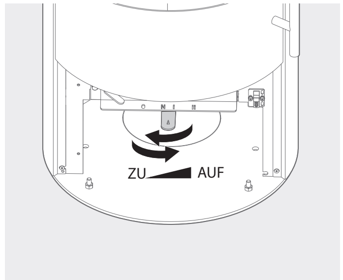
Abb. II Einstellen der Verbrennungsluft
