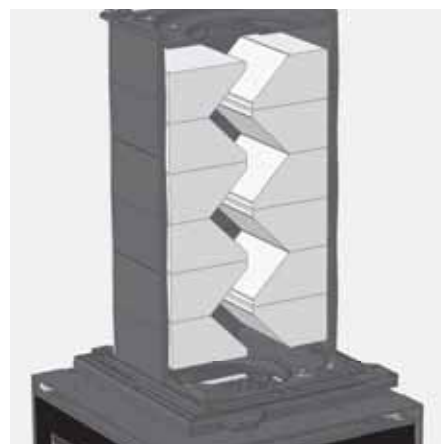
Abb. 4.50 Guss-Speicheraufsatz, Heizgasführung, Schnittdarstellung
