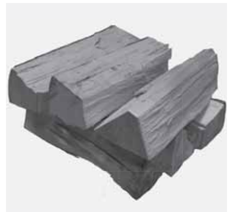
Abb. 4.9 Holzauflage für das Anheizen – ungefähr entsprechend der Holzauflage bei Nennwärmeleistung
