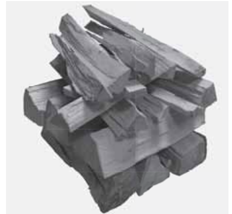
Abb. 4.12 gesamte Holzaufgabe beim Anheizen
