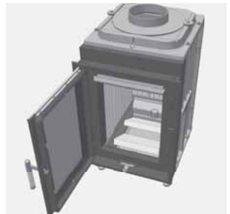
Abb. 4.29 Entnehmen der Bodensteine
