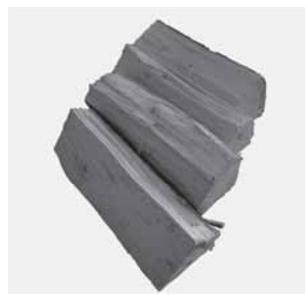
Abb. 4.19 Holzauflage bei TURMA XL DS: 4 Holzscheite in einer Lage, ohne Abstand zueinander und schräg ausgerichtet
