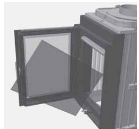
Abb. 4.31 Entnehmen der inneren Sichtscheibe
