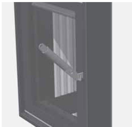
Abb. 4.2 Türverschluss und Bediengriff („kalte Hand“) bei linkem Türanschlag
