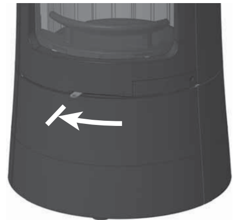
Abb. 4.24 Verbrennungslufthebel ganz links, Verbrennungsluft geschlossen
