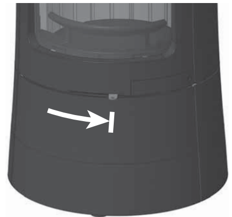
Abb. 4.11 Verbrennungslufthebel ganz rechts, Anheizstellung
