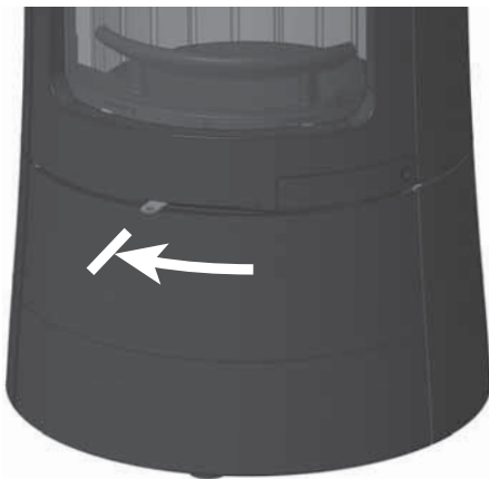
Abb. 4.9 Verbrennungslufthebel ganz links, Verbrennungsluft geschlossen
