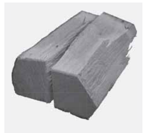
Abb. 4.21 Holzaufgabe mit 2 Holzscheiten – VISPA (ohne Wassertechnik), Auflage längs im Brennraum
